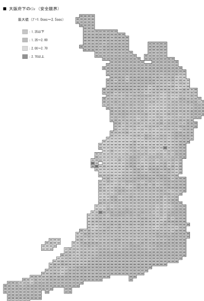
図3 大阪府Gsマップ Fig.3 Surface ground amplification map of Osaka Prefecture
