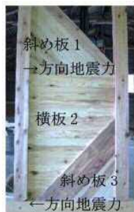
図3 複層斜交重ね板壁の構成方法(壁構面構成)
