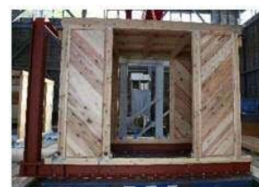
写真2 鉛直構面試験体
